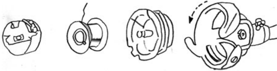
DE IZQUIERDA A DERECHA: La caja de canillas. La canilla. La pieza intermediaria. El garfio rotativo.
